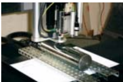
図1：大きく重いサンプルのAFM(原子力間顕微鏡)
